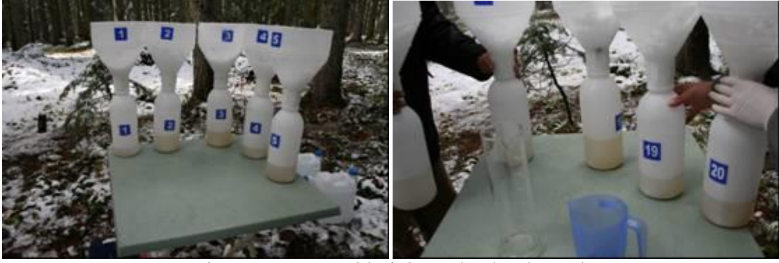
Resim 7. Yağış örneklerinin toplandığı kapanlar
