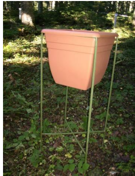
Şekil 3: Yapraklı Seviye 2 Gözlem Alanı Döküntü Aparatları Kurulum Şeması (24 adet)
