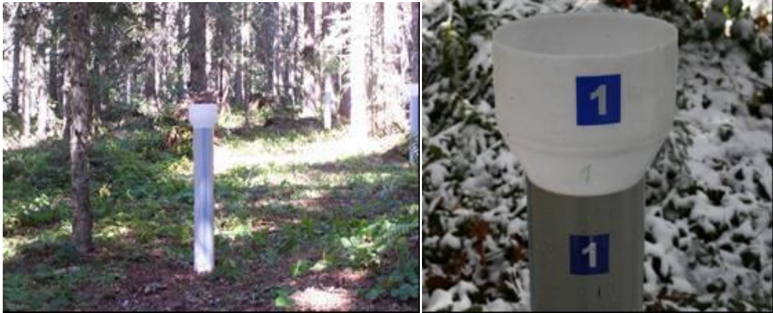
Resim 6. Yağış örneklerinin toplandığı kapanlara ait şekil
